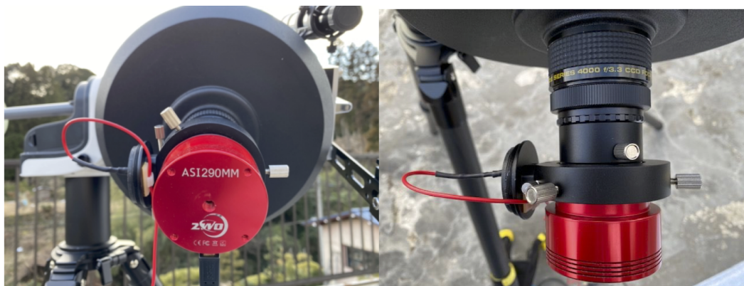
(a) ZWO 社の ASI290MM カメラの IMX290 センサー
