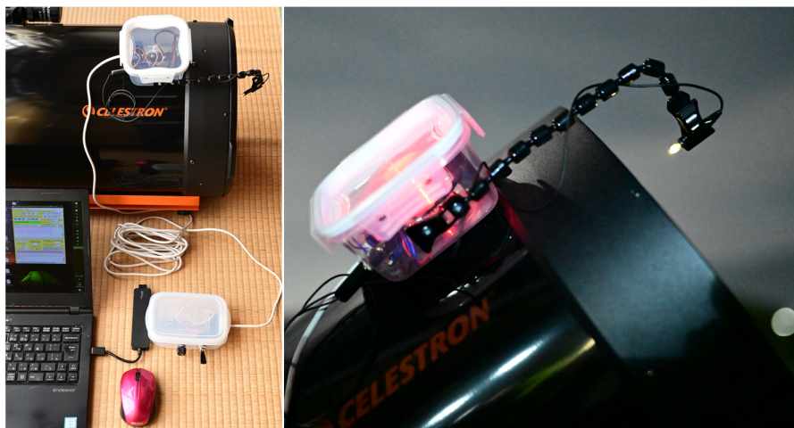
図 33: 受信装置の自作例（左）と，鏡筒先への設置（右）
