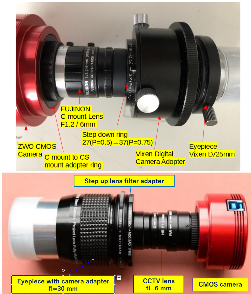
図 29: コリメート法を用いた縮小光学系構成例 上の図の例では焦点距離を 4.2 分の 1 にすることができ、F10 のシュミットカセグレンに装着すると口径比 F2.4 になる。下の例では焦点距離は 5 分の 1 になり、F10 の主鏡から口径比 F2 が得られる。
