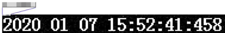
図 20: SharpCap がフレーム画像に記録する時刻値（拡大図）。これが画像にスーパーインポーズされる。左上端の 7 ピクセルには、ピクセルデータとして紀元 1 年 0:00:00 からの時間が 10^{-7} を単位として記録される。
